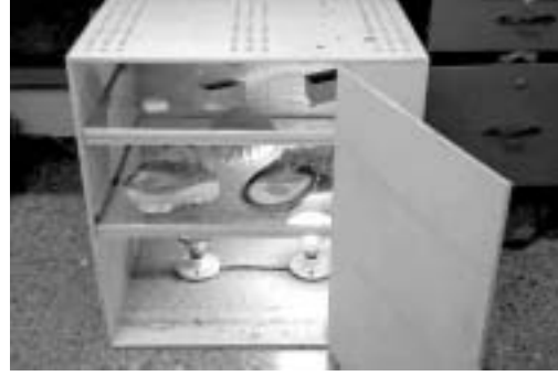
Fig. 22. Secadora. Al construir una secadora debe asegurarse de que posea además de una fuente de calor, orificios de ventilación por los que pueda escapar el vapor de agua. Este tipo de secadora puede utilizarse tanto para secar especímenes como para secar hojarasca.
