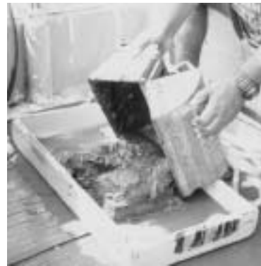
Fig. 29. La draga funciona como un par de cucharas que extraen parte del fondo. Se utilizan para sacar muestras de fondo suave. Algunos fondos duros también pueden ser muestreados con dragas sólo que requieren un resorte más potente para poder desprender el pedazo de sustrato.
