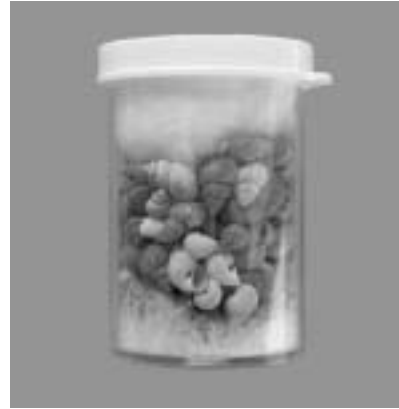
Fig. 31. Los especímenes frágiles deben transportarse en recipientes rígidos que los protejan de los golpes. El algodón es un buen medio para absorber los golpes y mantener los moluscos en una posición fija.
